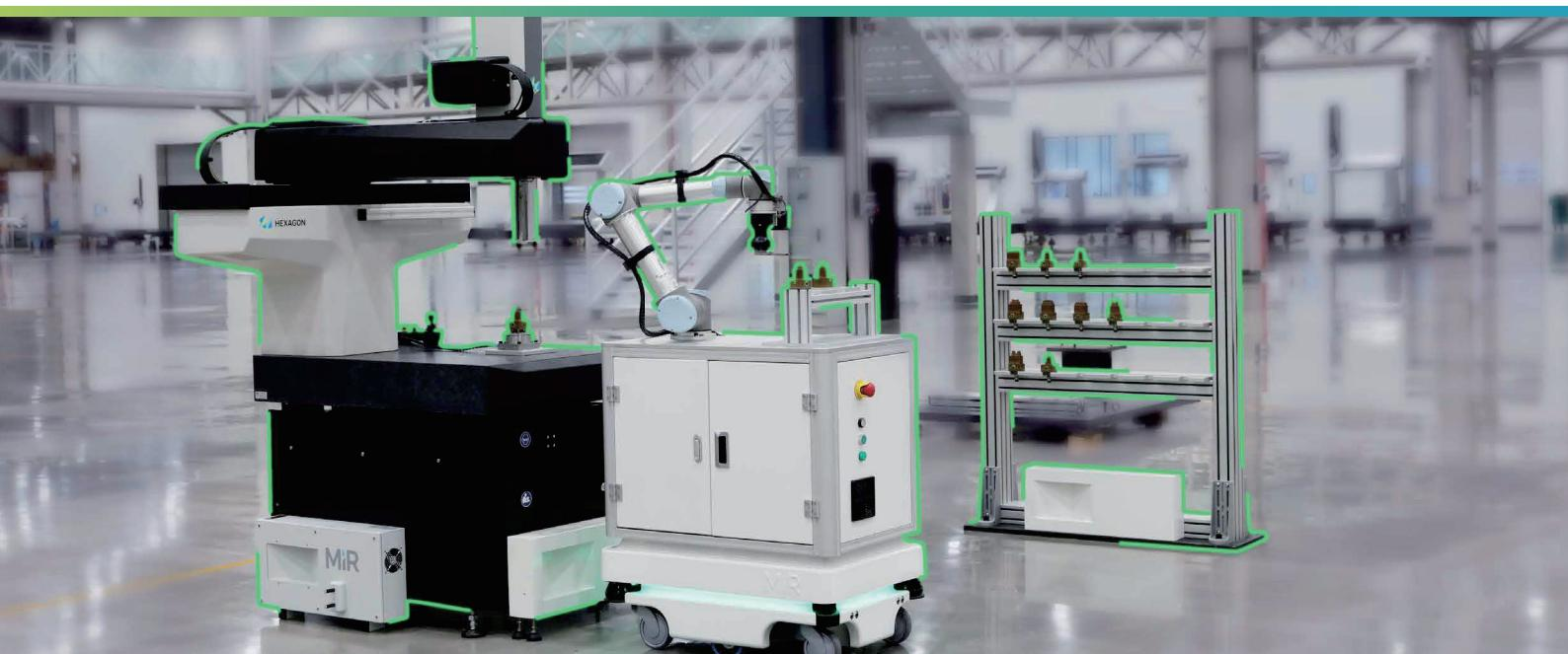
复合式机器人柔性检测方案包括 TIGO SF 565 车间型测量机、复合式机器人（协作机器人+AGV）、工业相机、料架、定位夹具等；可实现多种类产品的柔性化检测，工件的自动识别、自动上下料，自动检测，定位精准。该方案极大降低了人工成本，提高了设备利用率。
