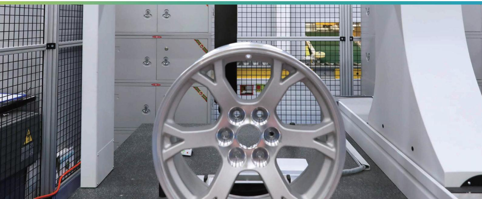
汽车轮毂柔性全自动测量方案，主要由三坐标测量机、自动料线，工件识别，位姿调整，机器人及抓手，自动夹具，自动测量控制系统等组成，实现轮毂的自动上下料，自动测量，数据自动保存及判定等功能。
