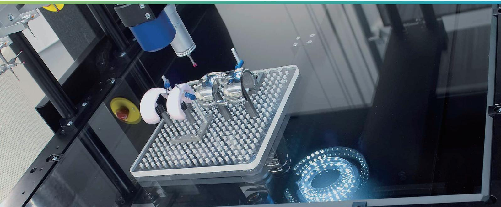
医疗零部件自动化检测系统集成了柔性智能化检测系统，对多种规格医疗零部件的自动识别、自动上下料，自动在线检测，自动下料分拣。安全防护等级高、极大降低了人工成本，提高了设备利用率。
